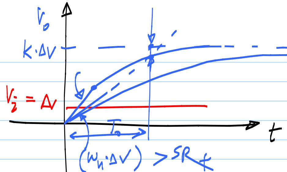
$$V_o = w_n \int (V_e + V_{o_{FT}} + v_h) dt$$
