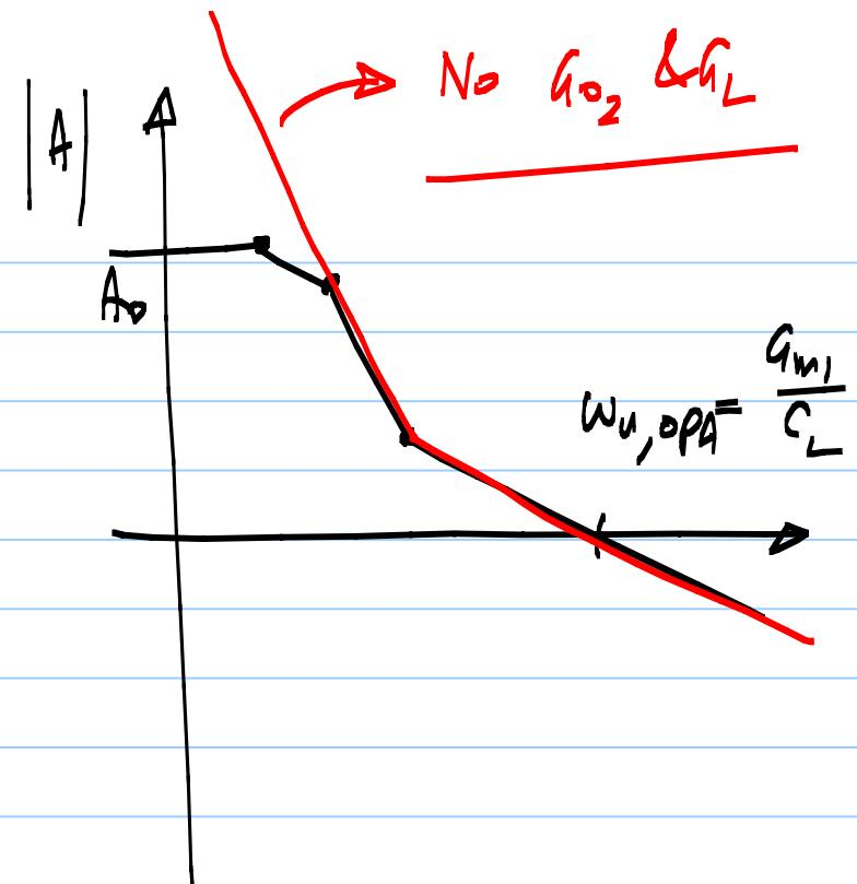
$$A(s) = \frac{V_o}{V_e} = \frac{\omega_n}{s} \left( 1 + \frac{z_1}{s} \right) = \frac{\omega_n}{s} \cdot \frac{z_1}{s} \left( 1 + \frac{s}{z_1} \right)$$
